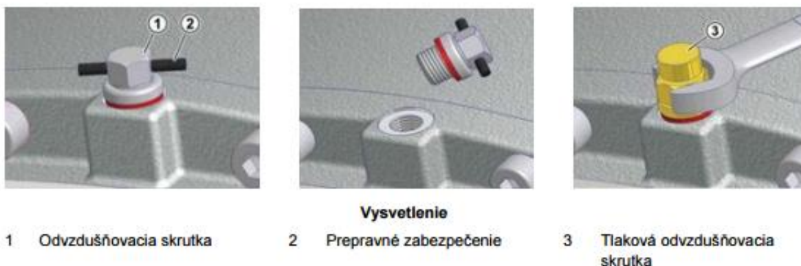
Obrázok 3: Odstráňte pôvodnú odvzdušňovaciu skrutku a namontujte skrutku tlakovú
